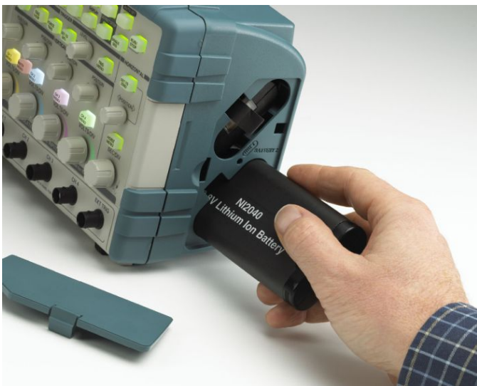
핫스왑(hot-swappable) 배터리를 사용하면 AC 전원 없이도 거의 무제한적으로 전원을 사용할 수 있습니다.
