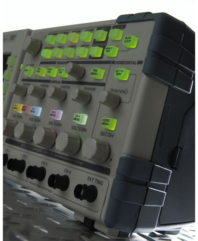
테스트 작업이 어려운 환경에서도 아날로그 스타일의 채널당 노브, 백라이트 메뉴 버튼 같은 기능을 통해 오실로스코프를 쉽게 사용할 수 있습니다.
