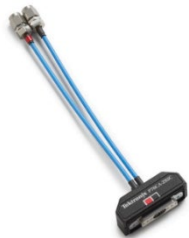
P76CA-292C 33GHz 대역폭 동축 어댑터, 2.92mm(수) 커넥터와 6인치 고성능 케이블 포함. 이 어댑터는 입력 커넥터에서 보정되며 2.92mm 또는 SMA 출력 커넥터가 있는 장치에 직접 연결하는 데 적합합니다.
